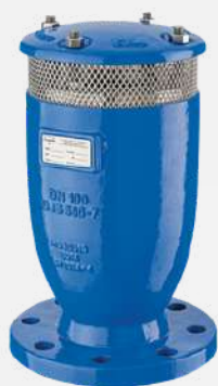
Ventosa quadrifunção passagem plena e reduzida, fechamento lento e anti-slam
